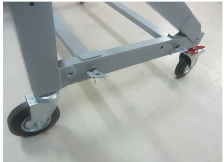
В сборке используются крепление фиксированными штырями и завинчивающимися барашками
